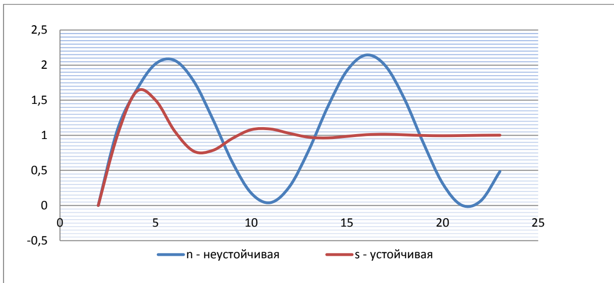
Рисунок 1 – Реакция устойчивой и неустойчивой систем к отклоняющему воздействию
